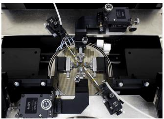
Зондовая станция MPI TS200-THZ предназначена для точных измерений в миллиметровом и терагерцовом диапазонах для пластин диаметром до 200 мм
